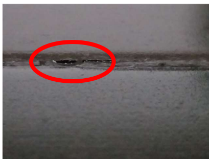
2. ábra: Kiválasztott folytonossági hiány - Hiányos összeolvadás
