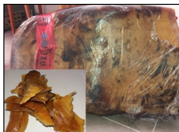
3.ábra: A kaucsuk kereskedelemben elérhető megjelenési formája
