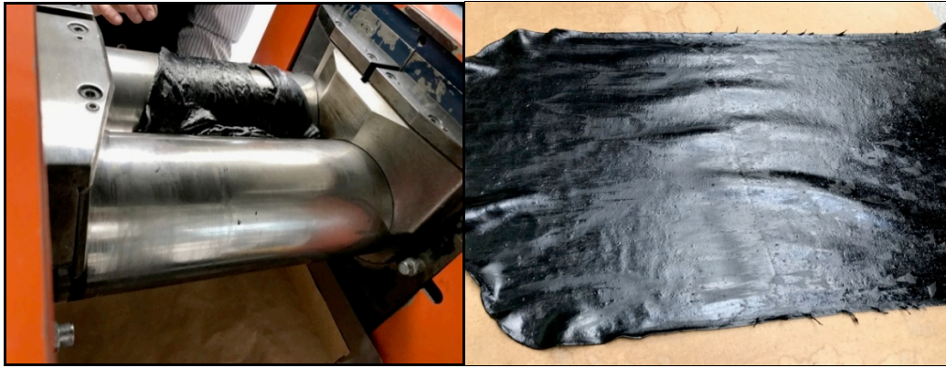
6. Ábra: Hengerlés 10 % frikció mellett illetve a kész palást
