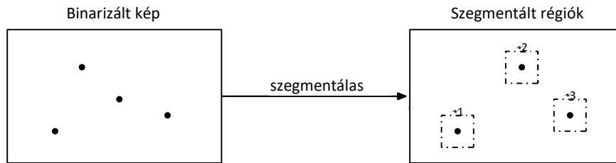
2. ábra. A szegmentálási lépés szemléltetése: a binarizált kép komponenseiből szaggatott határokkal kijelölt, szegmensenként jelölt régiók r_i keletkeznek.
