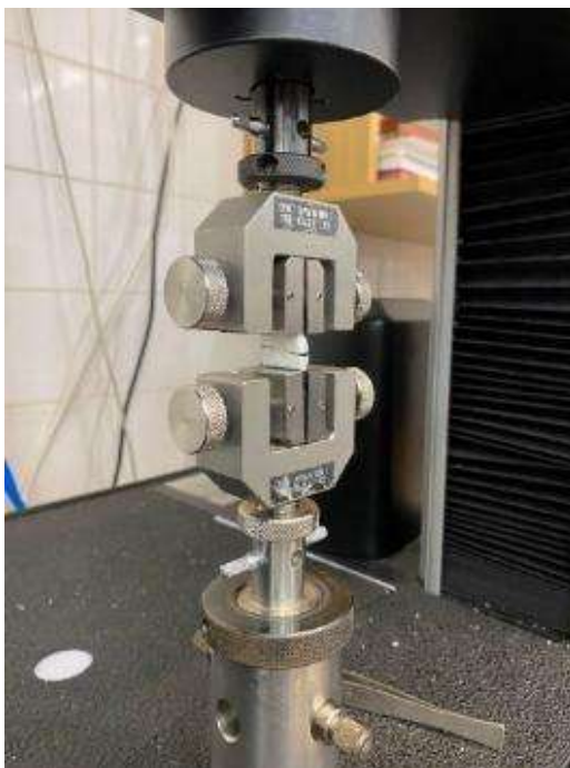
7. ábra: Egy jól sikerült szakítószilárdság mérés ábrája. A zselatin nem a befogás mentén, hanem középen szakadt el a szakítóterhelés hatására
