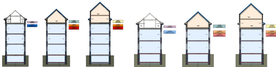
4. kép Tetőtérbeépítés-emeletráépítés elvi vonalvezetése – saját ábra
