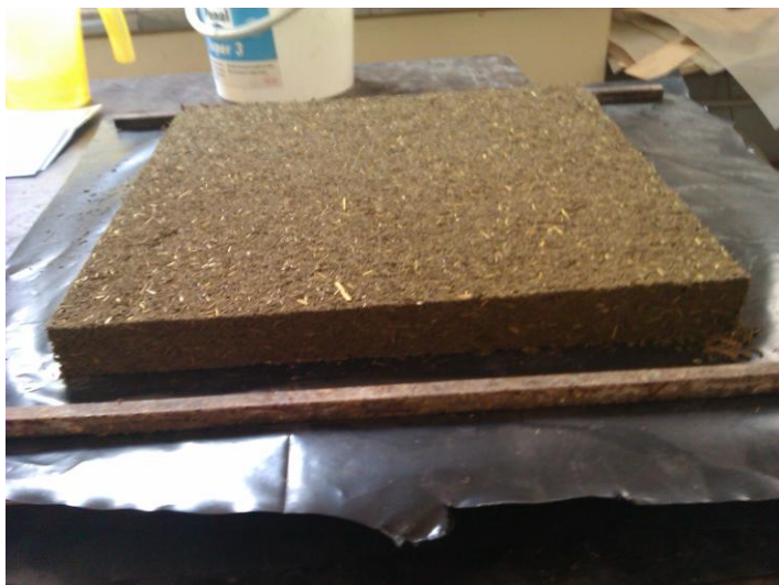
6. kép: Cementkötésű nádlap terítése
