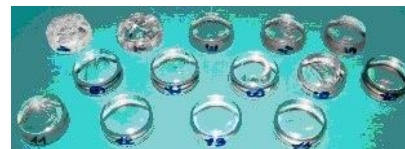
10. ábra. Fröccsöntött elő gyártmányból Préselt lencsék
