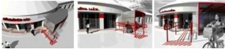
10. ábra. Művelődési Ház és Könyvtár épületének komplex akadálymentesítése – főbejárat komplex akadálymentesítésének kialakítása
