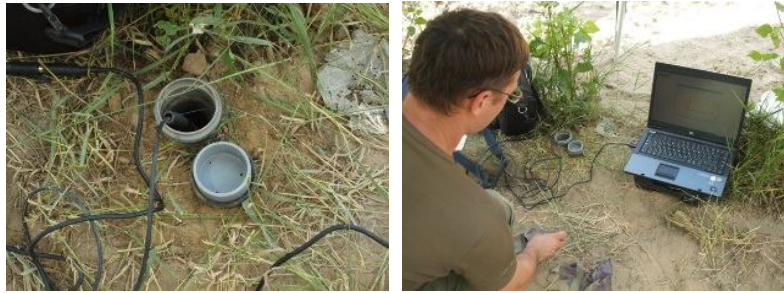
5-6. ábra: Telepített 4 m mélységű talajvízkút és adatainak rögzítése
