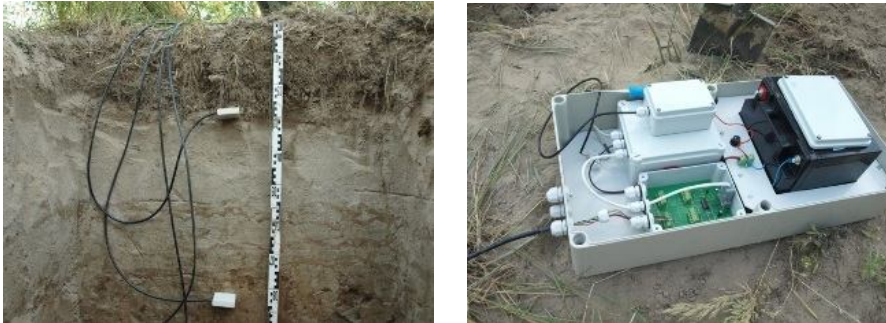
8-9. ábra – TRD-szonda telepítése és adatainak rögzítése
