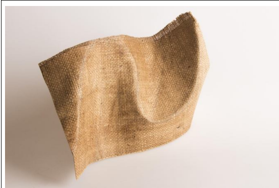
Ívelt hajtással merevített biokompozitlap
